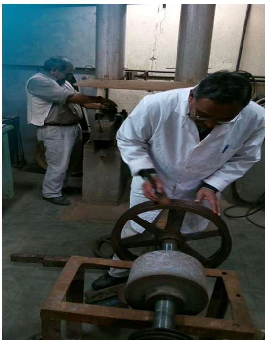
Foto N 5.- Técnicos L. Flores y B. Cruz, realizando trabajos de mantenimiento en las trituradoras de la sala de molienda.
